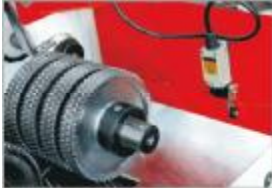
进料口安全限位装置。 Safety limit switch at in-feed end.
