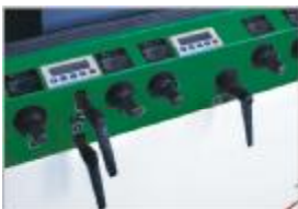
左立轴、最后上刀轴可装 SIKO 机械和磁栅数显装置。 Left spindle / last upper spindle: SIKO mechanical or magnetic grating digital readout
