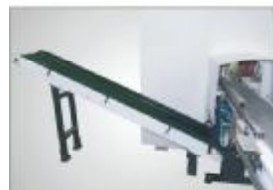
废料输送架，自动输送废料，节省人工。 Automatic waste material delivering unit
